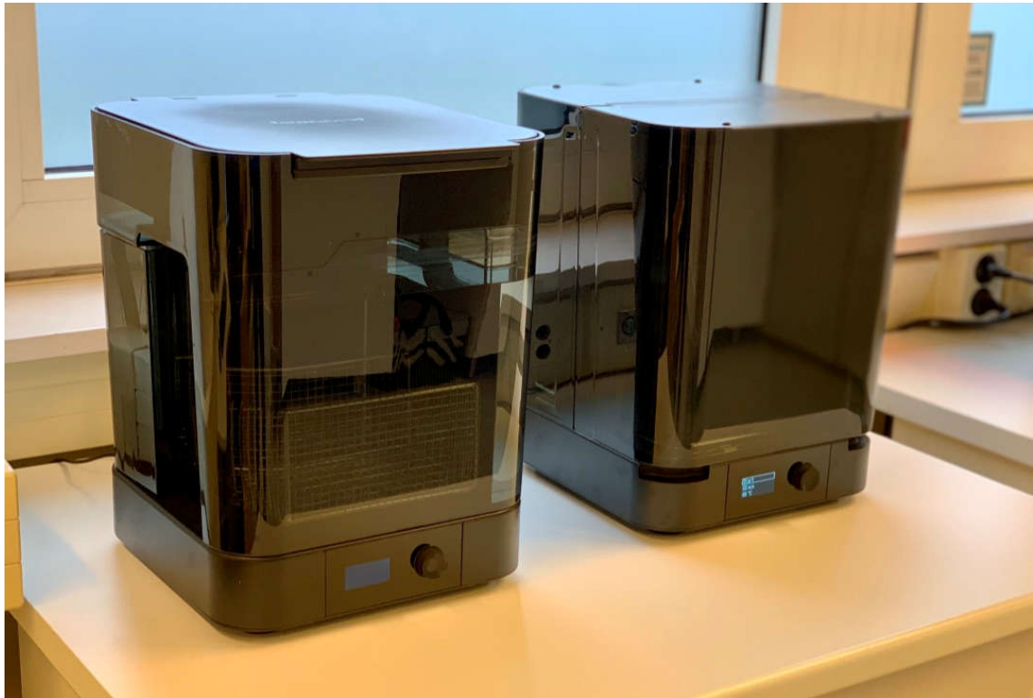
Når 3D-modellene er ferdig printet med «laser-printeren», må de rengjøres i disse to maskinene før de er klar til bruk. Foto: Geir Andre Pedersen.
