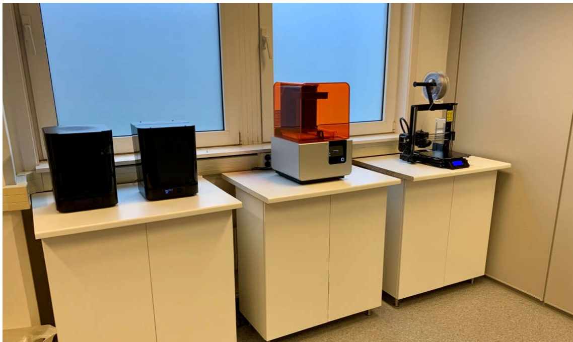
To 3D-printere er på plass på FOR-NorMITs 3D-print lab ved St. Olavs hospital! Det er SLA og FDM-teknologi som i førsteomgang er tatt i bruk. Her produseres modeller for bruk ved ulike avdelinger som f.eks. ortopedien, stråleterapi, kjevekirurger, hjerte-kar osv. Ta kontakt for å vite mer! Foto: Geir Andre Pedersen.
